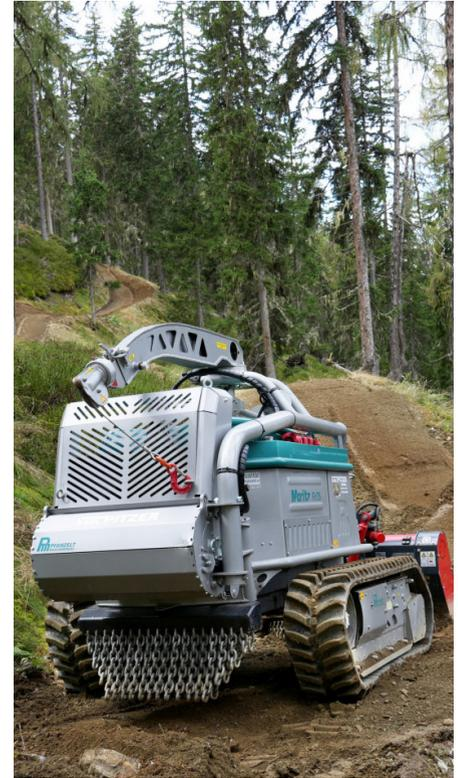
Highlight: die optionale Traktionsseilwinde mit bis zu 1.000 Meter Seil – für stabilen Einsatz auch in extremen Gelände.
