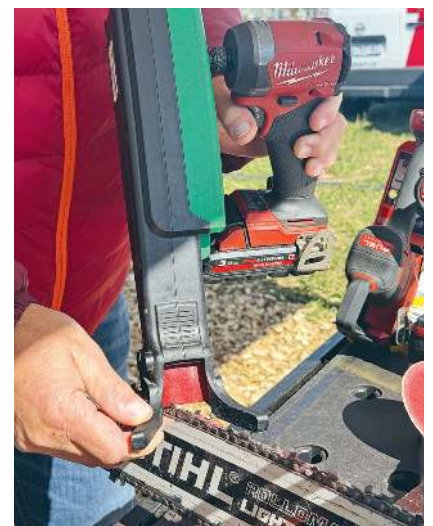
Der Schleiferl von Bast Ing sorgt für eine optimale Schleifqualität der Sägekettens.
