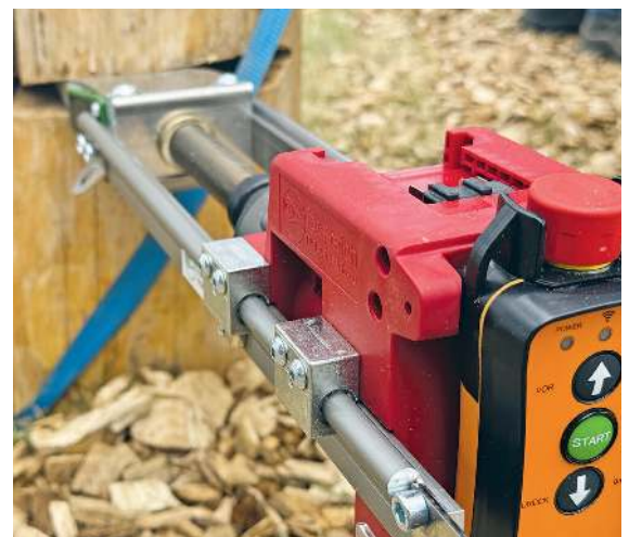
Die mechanischen Fällkeile von Forstreich sorgen für eine sichere Fällung, der TR27-HD bringt 24 t Druckkraft.
