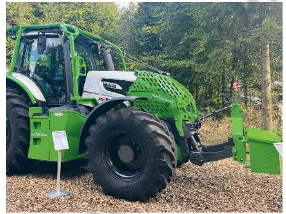
Reil und Eichinger stellte einen Forstschlepper mit Werkzeugbox vor, der auf der Q-Serie von Valtra basiert.
