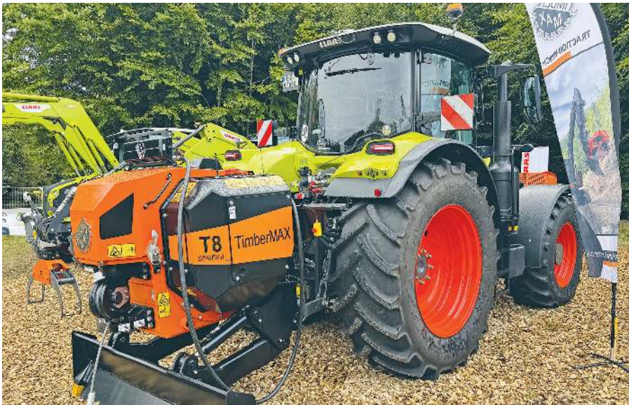
Agravis zeigte zahlreiche umgerüstete Claas-Schlepper, die mit Forstgeräten ausgestattet wurden. Hier die Traktionswinde T8 von TimberMax. Sie zieht konstant 8 t und auf der ersten Lage auch 14 t.
