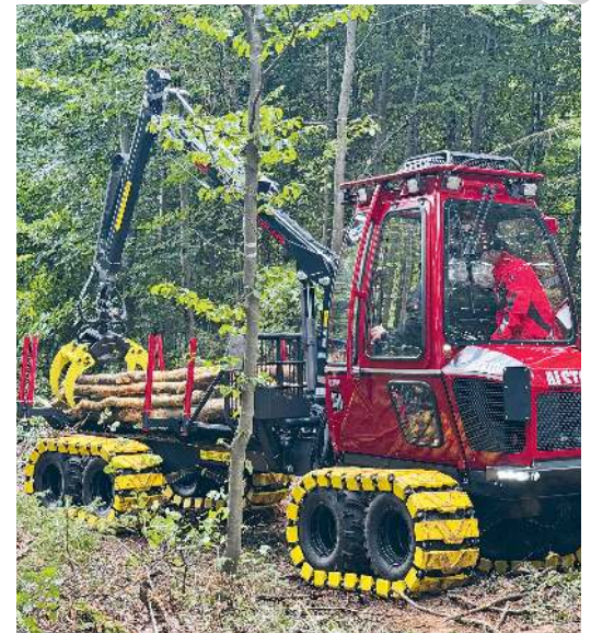
Nicht immer müssen es große Maschinen sein, die hilfreich sind. Die Kleinrückefahrzeuge von Alstor ermöglichen bodenschonendes Arbeiten.
