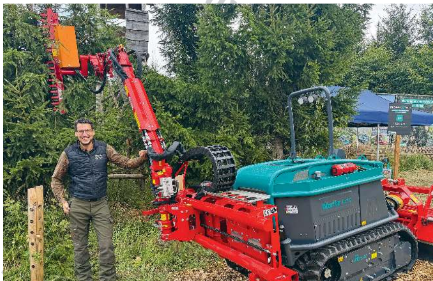
Peter Vorderholzer von der Firma Pfanzelt stellte ein weiteres Einsatzgebiet für den Moritz vor: Das Anlegen eines Lichtraumprofils mit Dücker Astschere und Mulcher.
