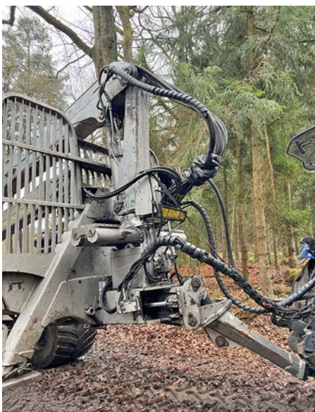
Die gefederte Deichsel lässt sich hydraulisch anheben und hydraulisch zu jeder Seite schwenken.
