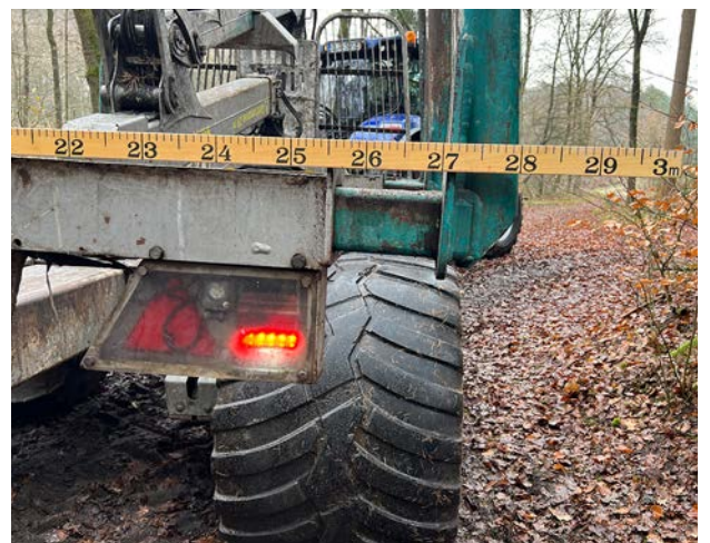
Rechts: Die Rungen sind jetzt 150 Millimeter ausgezogen, können aber bis 300 Millimeter je Seite ausgezogen werden.
