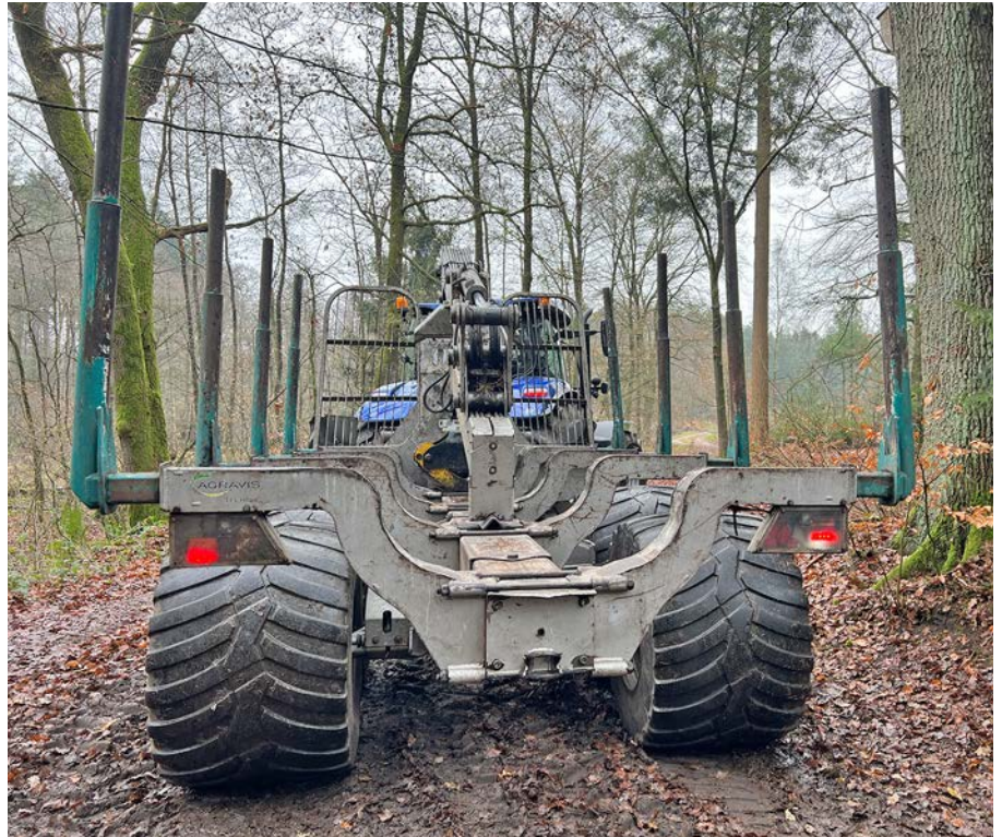
Beeindruckend, aber nicht in den Boden drückend. Mit den 800er Schlapfen läuft der Anhänger gut über.
