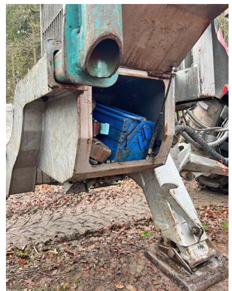
Zwischen Stirngitter und erster Rungenbank ist an jeder Seite des Hängers ein Staufach angebracht.
