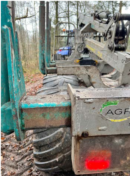
Ausziehbare Rungen erhöhen das Ladevolumen.
