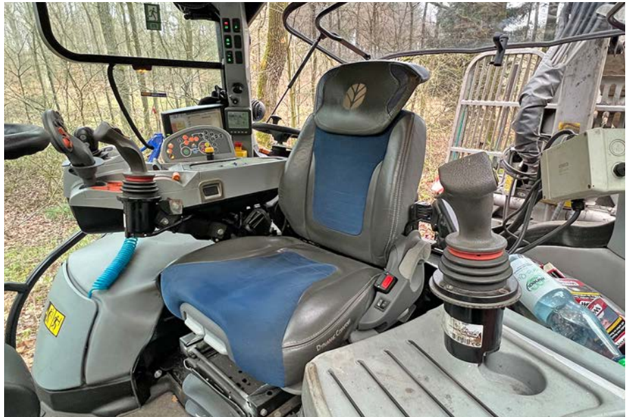
Der New Holland besitzt eine fahrerfreundliche Kabine. Die Joysticks sind am Drehsitz befestigt.
