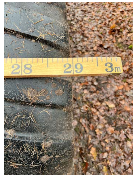
Trotz 800er Bereifung beträgt die Breite des Hängers insgesamt nur 2.900 Millimeter. Fotos: Biernath
