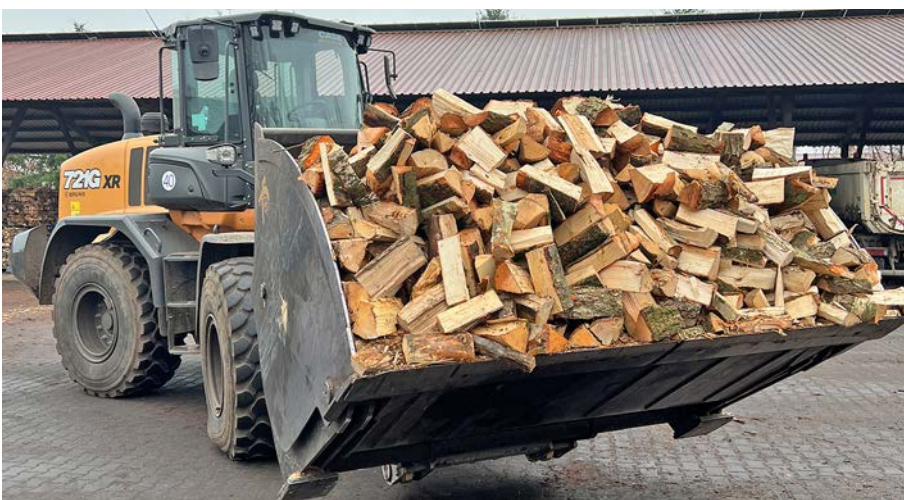
Fünf Kubikmeter Brennholz gehen in die Ladeschaufel.
