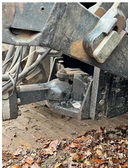
Die spielfreie Kugelumlaufgelenk schont Schlepper und Geräte und erhöht somit deren Lebensdauer.
