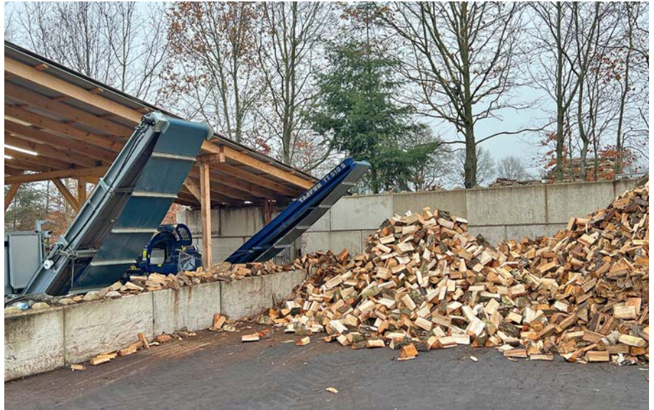
Hier wird Brennholz erzeugt. Der Binderberger (vorne) ist für die dicken Dinger zuständig, der Tajfun für das etwas schwächere Holz.
