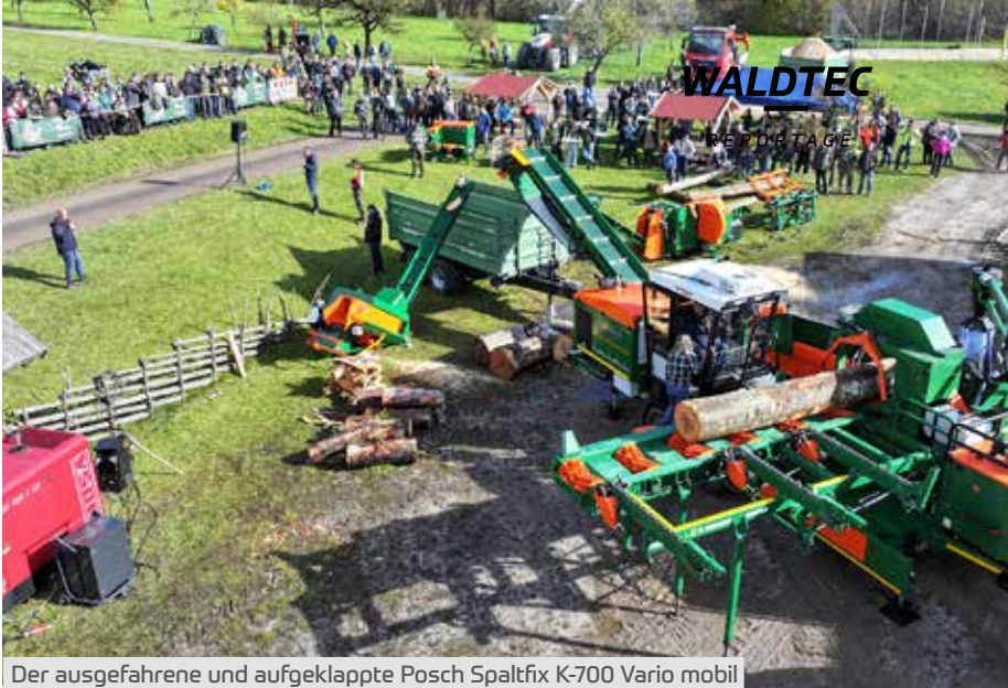
Der ausgefahrene und aufgeklappte Posch Spaltfix K-700 Vario mobil wurde vom Pfanzelt Rückewagen mit Stämmen bis zu 4 m versorgt.
