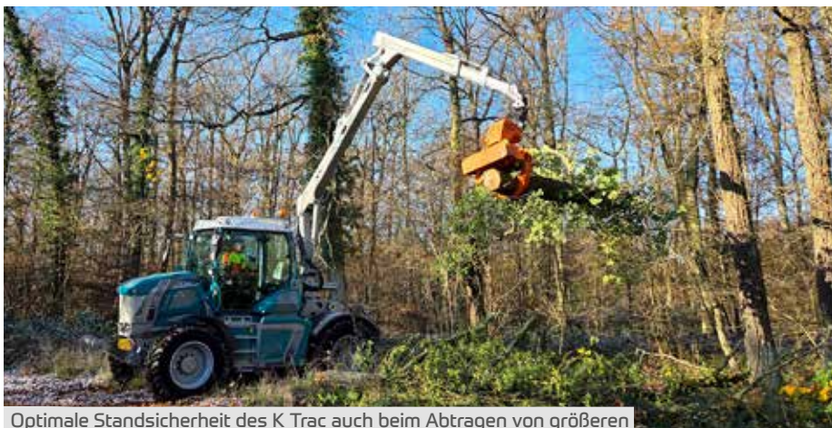
Optimale Standsicherheit des K Trac auch beim Abtragen von größeren Bäumen mit dem Fällgreifer durch die automatische Achsverblockung
