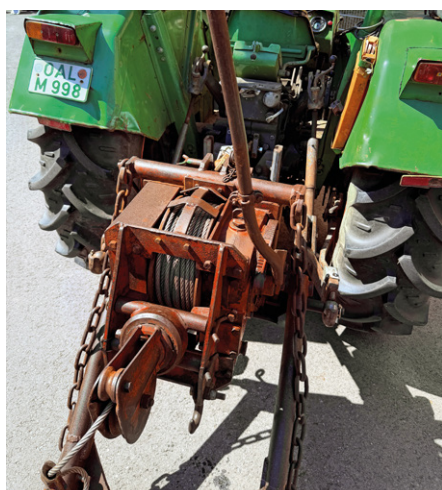
Handhebelwinde von Schlang & Reichart aus dem Jahr 1973
