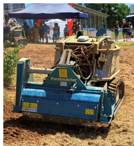
Der Geräteträger Moritz FR75 war erstmals mit einer autonomen Steuerung zu sehen.
