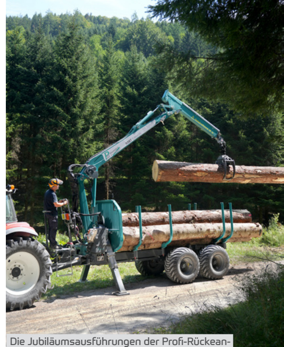
Die Jubiläumsausführungen der Profi-Rückeanhänger verfügen über leistungsstarke Kranpakete, eigene Ölversorgung, innenliegende Schlauchführung bis zum Pendel, LED-Arbeitscheinwerfer und Abstützteller.
