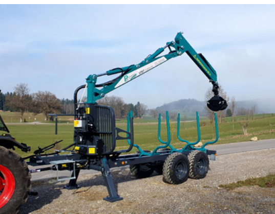
Der kompakte S-line S8 Edition35 kommt u.a. mit Pendel samt innenliegenden Schläuchen.
