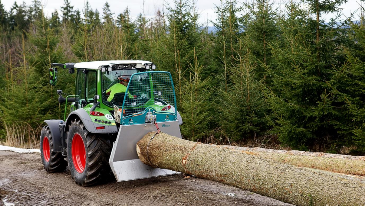
Abbildung 1: Die S-line Seilwindenbaureihe umfasst Seilwinden mit Zugkräften von 5 bis 7,2 t
