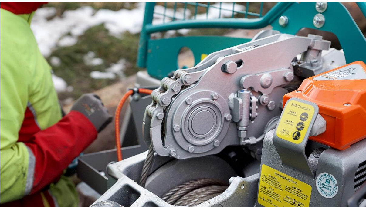
Abbildung 2: Der optional erhältliche Seilausstoß und die automatisierte Trommelnachlaufbremse erhöhen die Sicherheit und den Bedienkomfort.
