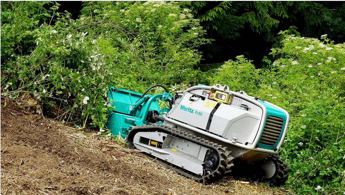
Abbildung 1: Moritz mit Forstfräse beim Mulchen von Gestrüpp und Gehölz bis 20 cm Durchmesser
