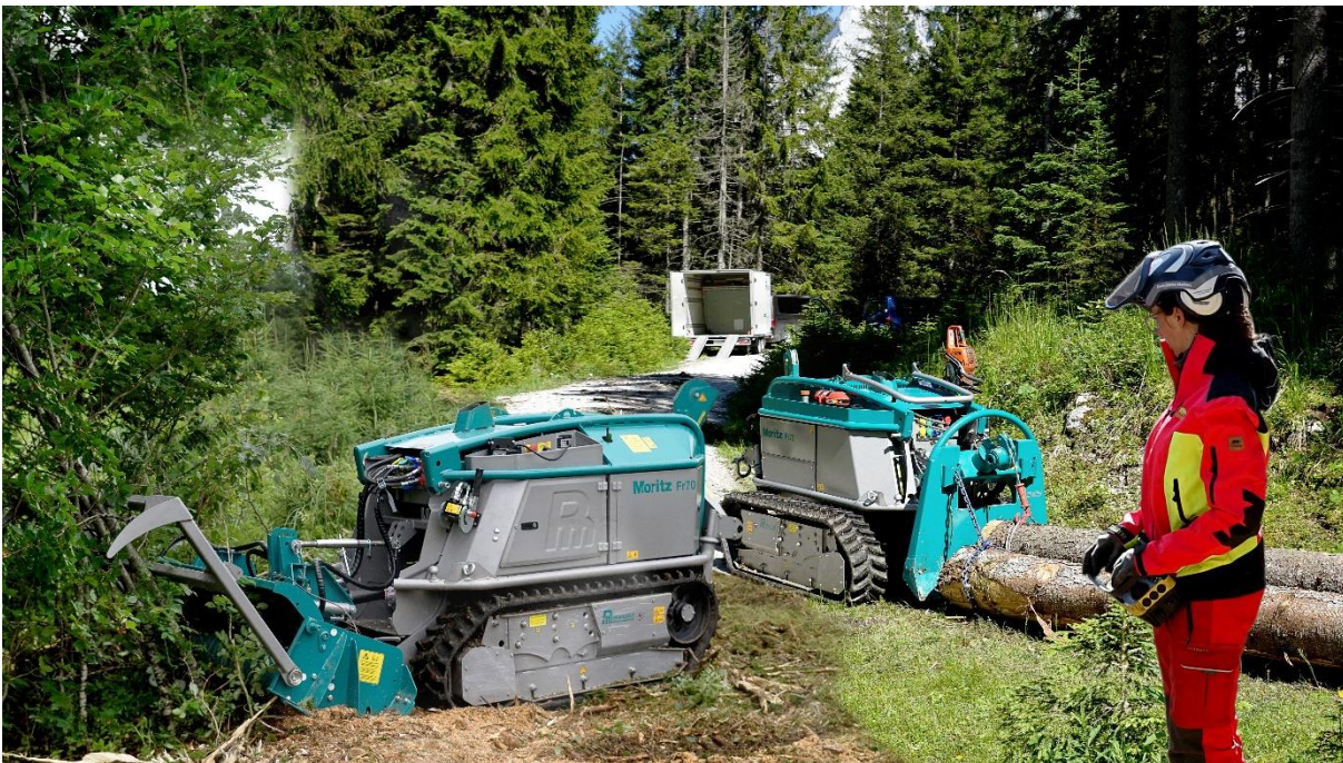
Abbildung 1: Die neue Forstfräse MAX ist von den Leistungsdaten und Abmessungen angepasst an die neue Baureihe der Forstraupe Moritz.
