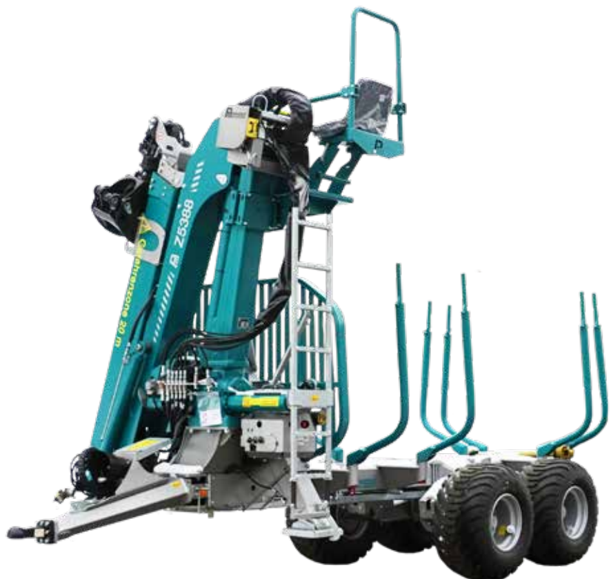
Remorques forestières Pfanzelt Profi P13 avec grue Z 5388, siège haut et radiocommande
