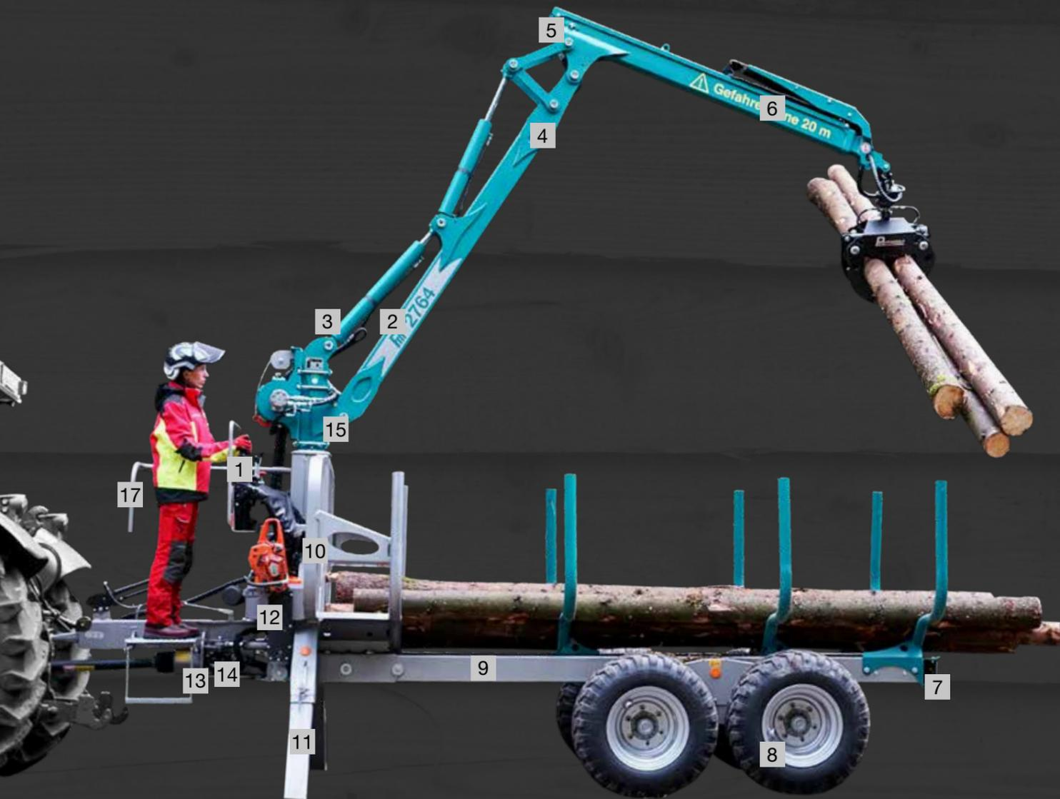
**1** Commande ergonomique avec commande à joystick.
