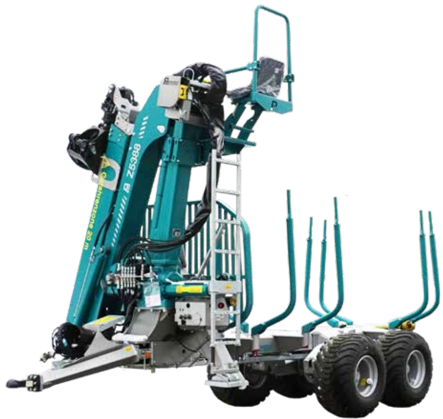
Pfanzelt Profi Rückeanhänger P13 mit Z-Kran 5388, Hochsitz und Funksteuerung
