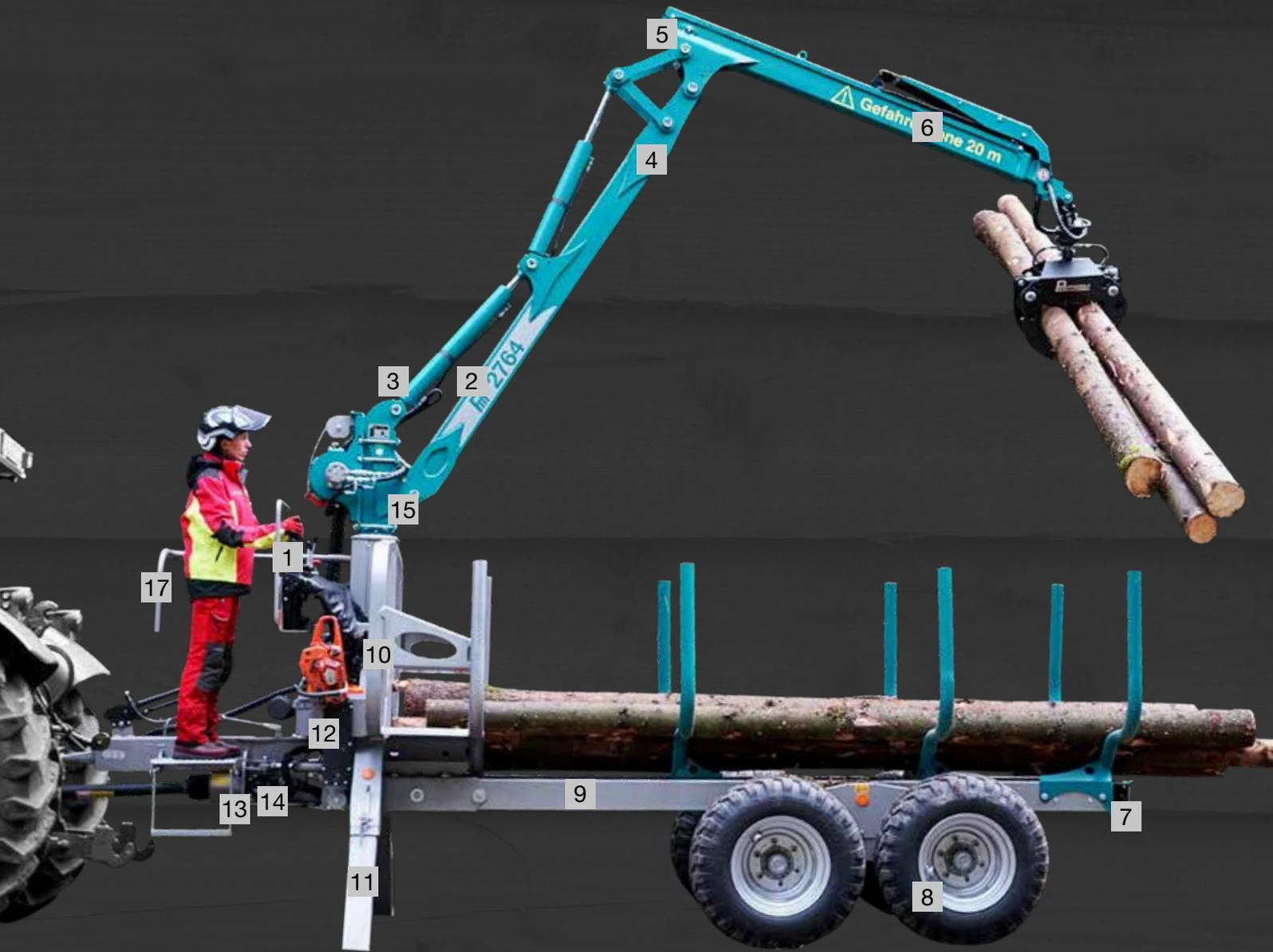
**1** **Commande ergonomique** avec commande à joystick.
