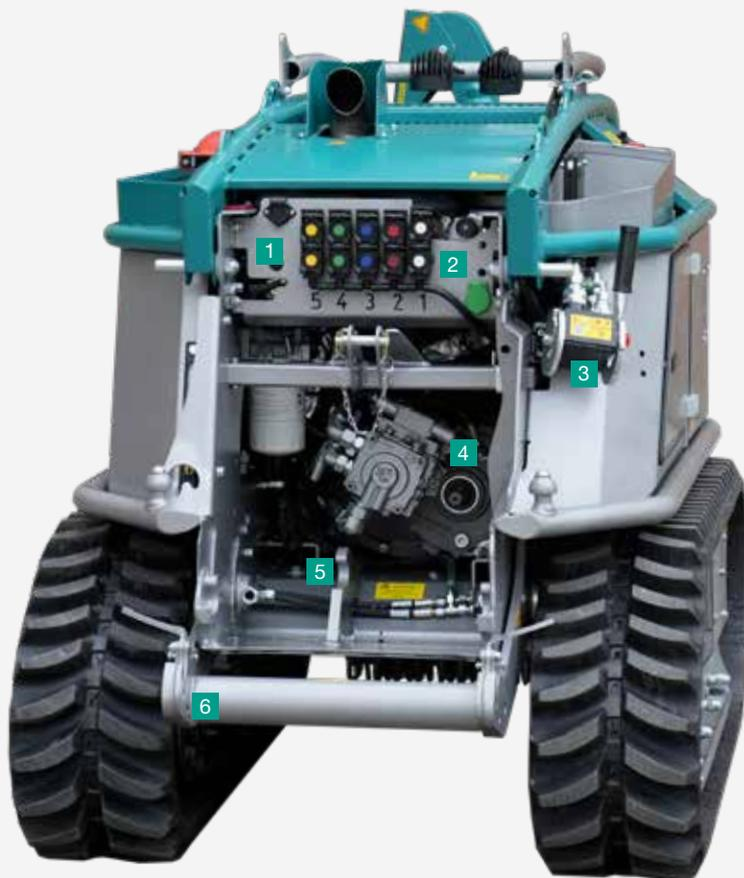
**1** Circuit hydraulique embarqué avec jusqu'à 4 unités de commande proportionnelles et 2 unités de commande double effet n/b.
