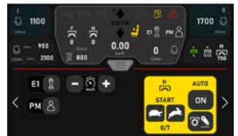
Outre la présélection de la vitesse et de la caractéristique de démarrage, la gestion de la prise de force permet également de pré-régler un système d'activation et de désactivation automatique.
