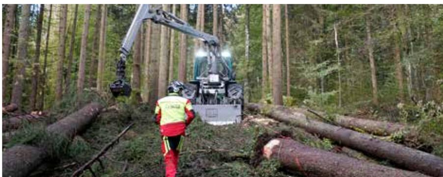
Dans le cas de Pm Trac, les unités de treuils Pfnzelt sont montées sous la grue forestière, au-dessus de l'essieu arrière.
