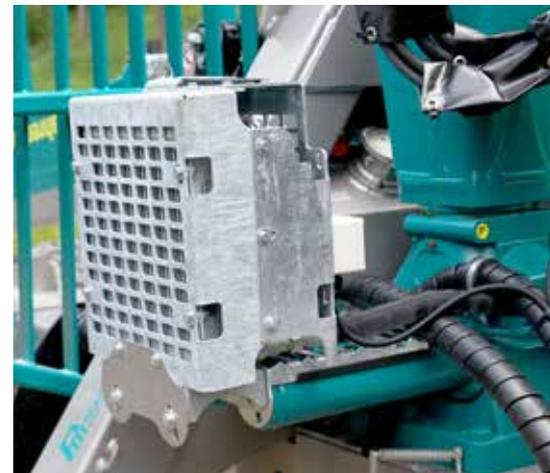
**Système de refroidissement de l'huile hydraulique (en option)**
