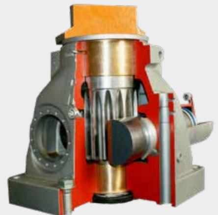
La grande distance entre les paliers et le dispositif de lubrification à bain d'huile assure un fonctionnement fiable. Les forces de tension liées à des travaux avec des grumes lourds sont ainsi absorbées en toute sécurité.
