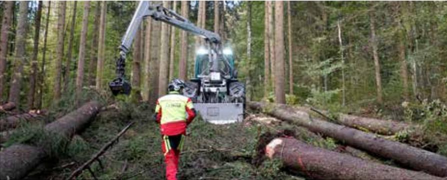
Die Pfanzelt Seilwindenaggregate werden beim Pm Trac unter dem Forstkran über der Hinterachse montiert.
