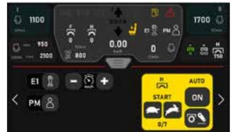
Neben der Vorwahl der Geschwindigkeit und der Anlaufcharakteristik kann im Zapfwellenmanagement auch eine Ein- und Ausschaltautomatik voreingestellt werden.
