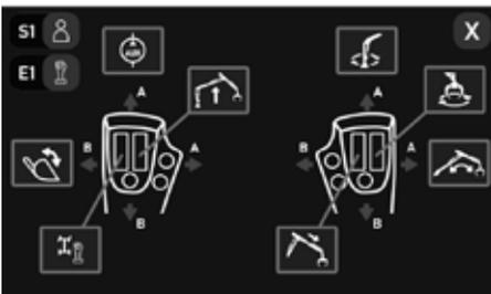
Angepasst an den Fahrer kann dieser die Belegung aller Joystickfunktionen und Bedienhebel für hydraulische Steuergeräte am Bedienerstand individuell vorwählen und im Fahrermanagement abspeichern.
