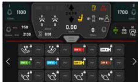
Das Hydraulikmanagement ermöglicht die Voreinstellungen für alle Kranfunktionen (inkl. der Mengenregulierung, der Anpassung der Charakteristik der einzelnen hydraulischen Funktionen und der Rampen).
