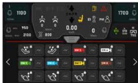
La gestion hydraulique permet d'effectuer des pré-réglages pour toutes les fonctions de la grue (y compris le réglage du débit, l'adaptation des caractéristiques des différentes fonctions hydrauliques et des rampes).
