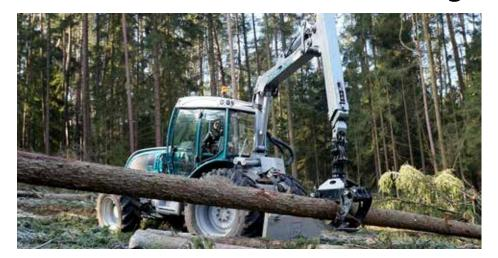
Der Systemschlepper Pm Trac III ist dank seines einzigartigen Fahrzeugkonzeptes optimiert für den kombinierten Einsatz in der Land- und Forstwirtschaft sowie der Landschaftspflege. Zu den Highlights des Pm Trac Maschinenkonzeptes gehören der zentrale Aufbauraum über der Hinterachsmitte und die schnelle und flexible Anpassung an verschiedene Arbeitsbedingungen.
