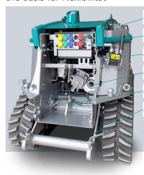
Bordhydraulik mit bis zu 4 proportionalen und 2 s/w doppeltwirkenden Steuergeräten.
