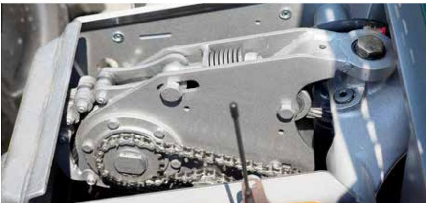
Seilverteilung mit Seilausstoß und integrierter Seileinlaufbremse
