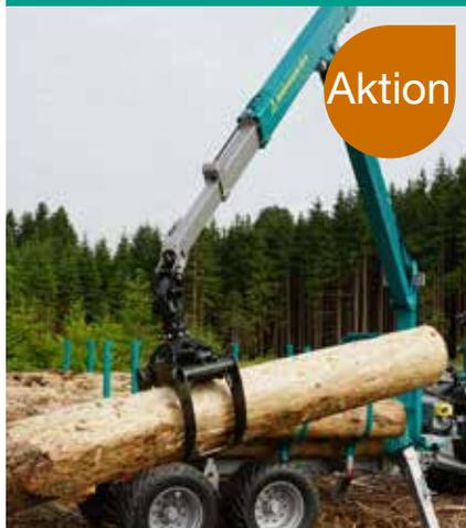
Pfanzelt Doppelteleskop-Krane bieten eine größere Kranreichweite und eine schnellere Krangeschwindigkeit. Eine geschützte Schlauchverlegung bis in die Kranspitze ermöglicht geringe Ausfallzeiten.
