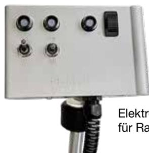
Elektronische Bedieneinheit für Radnabenantrieb
